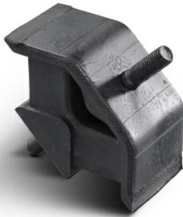
Il supporto AMC-Mecanocaucho® tipo VD lavora l'elastomero a compressione e taglio. È composto da due parti metalliche che ne consentono l'installazione per mezzo di due viti incorporate.
