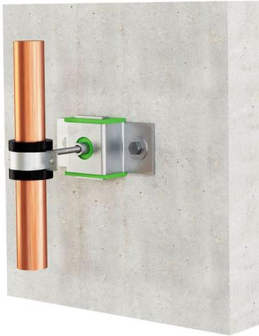
Gama diseñada para la suspensión flotante de paredes insonorizadas. El Sylomer® evita la transmisión de vibraciones obteniendo resultados acústicos óptimos. Poseen una estructura metálica robusta a prueba de sobrecargas "FAIL SAFE". Su aplicación es recomendada en aplicaciones donde la resistencia al fuego o choques sea necesaria. Estos soportes son también aptos para el aislamiento de tuberías verticales, o cualquier tipo de conductos de poco peso que requieran ser aislados.
