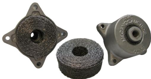
Il suo specifico design, consente di ottenere valori di rigidezza simili a trazione e compressione. Questa caratteristica è particolarmente utile nelle applicazioni dove le vibrazioni in senso verticale sono predominanti. Le parti metalliche sono robuste e incorporano un dispositivo in sicurezza per resistere alle forze di trazione.
